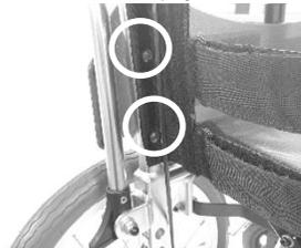
(3) (2)でビスを外した箇所へ、同梱の新しいタッピングビスM5\*16(⑨)を使用して、ステアAを背パイプに固定します。その際、ブレーキワイヤーはステアA、Bとウイングの支点の間を通してください。ステアA、Bより後ろにある場合、ウイングの作動時にワイヤーをはさみ破損する恐れがあります。※ねじ穴の破損によりビスが固定できなくなった場合は、ドリルφ5.0でビスが取り付けいていた穴を加工してから、補修用ビスM6\*16(⑩)で固定してください。
