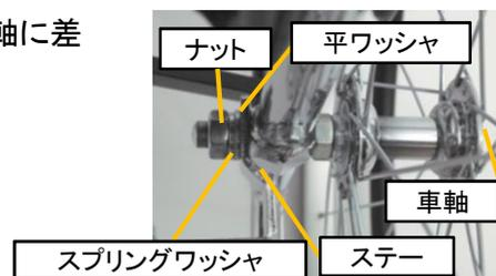
6. 転倒防止パイプ下側のボルトをレンチ等で締めます。ボルトを抑えたままナットをスパナなどで固定します。
