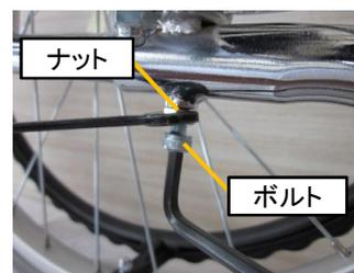
7. ボンベ架・駆動輪にガタつきがないことを確認します。また駆動輪がスムーズに回転することを確認します。
