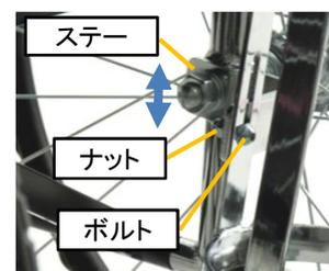
5. 作業3で外した平ワッシャ、スプリングワッシャ、ナットの順番で車軸に差し込み、作業3の要領でナットを固定します。
