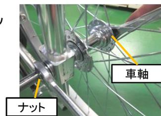
4. ステア凹部がバックパイプにあうように、ボンベ架の転倒防止パイプをテッティングバーに差し込みます。ステアを車軸の位置に調整します。調整後、作業2の要領でステア部のナットを固定します。
