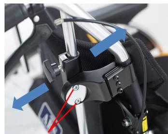
左右のキャップボルト(写真左)計4本をM5六角レンチで緩め、ヘッドサポートの角度を任意の位置にあわせてください。
