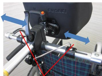
①. 2箇所のボタンキャップボルトを3mmの六角レンチで緩めます。
