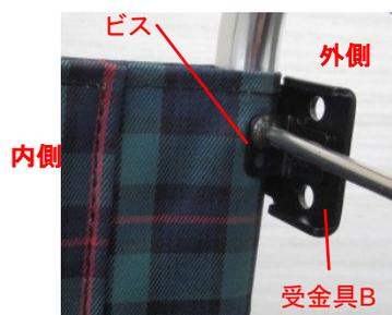
①. 車いす本体の背シートを固定しているビスをプラスドライバーを使用して外します。
