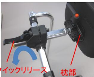
③. ヘッドサポートフレームのクイックリリースを手前に倒し、枕部を左写真のように差し込みます。
