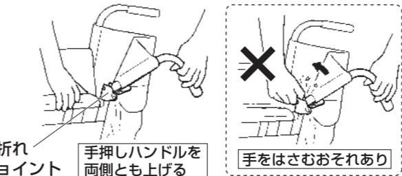
3 シートパイプの両端を手の平で押し下げます。
