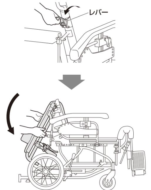
\*フット・レッグサポート、転倒防止バー、アウターシートを外すと、よりコンパクトに折りたためます。
