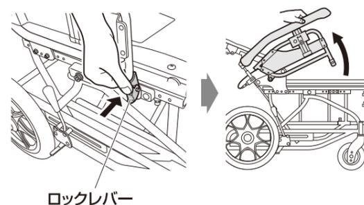
\*アームサポートフレームを上げた状態で、アームサポートフレームに力を加えないでください。フレームが変形し故障の原因となります。
